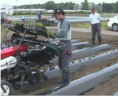
図1 挿苗機による挿苗作業
