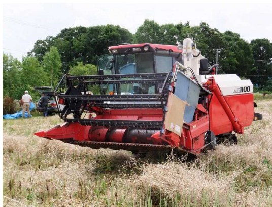
写真1 改良ヘッダ（テーブルを 10cm 前に延長）＋サイドカッタ
