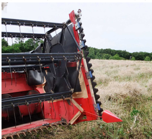
写真2 サイドカッタの取付状況（リールに隣接する位置に取付）
