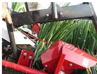
写真12 ベルト手前でのつまり
