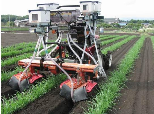
写真1 試作機培土作業
