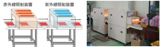
図2 光殺菌装置の概略図（左）と産地での活用の様子（右） 赤外線で果実表面温度を上昇させ、続けて紫外線を照射することで高い殺菌効果が得られる。
